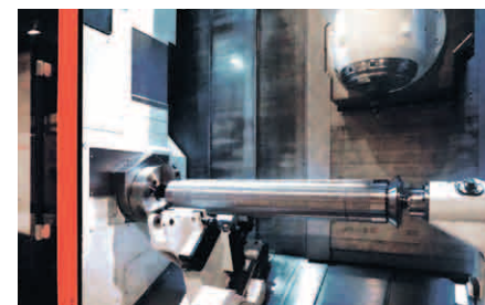
使用INTEGREX e-500H II，进行一次性卡夹对滚筒进行全加工
