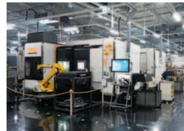
在前后2台的INTEGREX上各自装载机械臂的自动化系统
