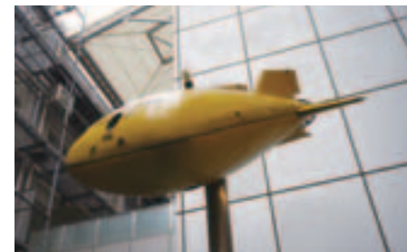
马扎克机床所制造的自律航行型海中机器人「普特罗阿150」
