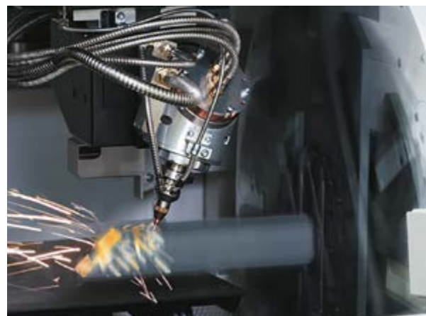
La testa tiltante di FT-150 FIBER permette taglio bevel e la svasatura di fori
