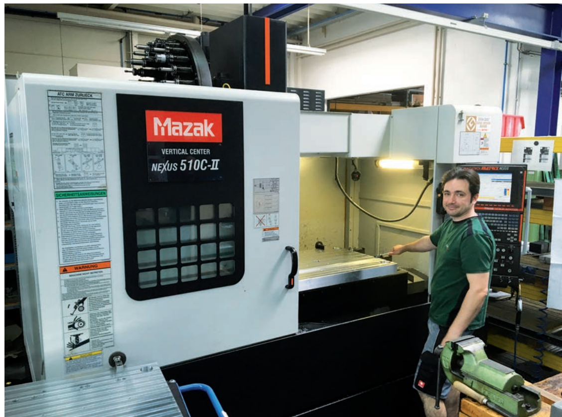
2008 ging die zweite Mazak Maschine - ein Vertikal-Bearbeitungszentrum Nexus - bei ZIPO in Betrieb.
