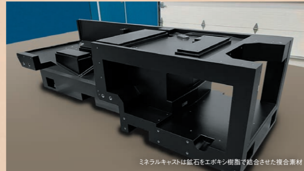
ミネラルキャストは鉱石をエポキシ樹脂で結合させた複合素材
