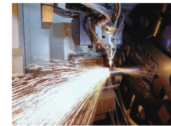
レーザー加工機によるパイプ加工
