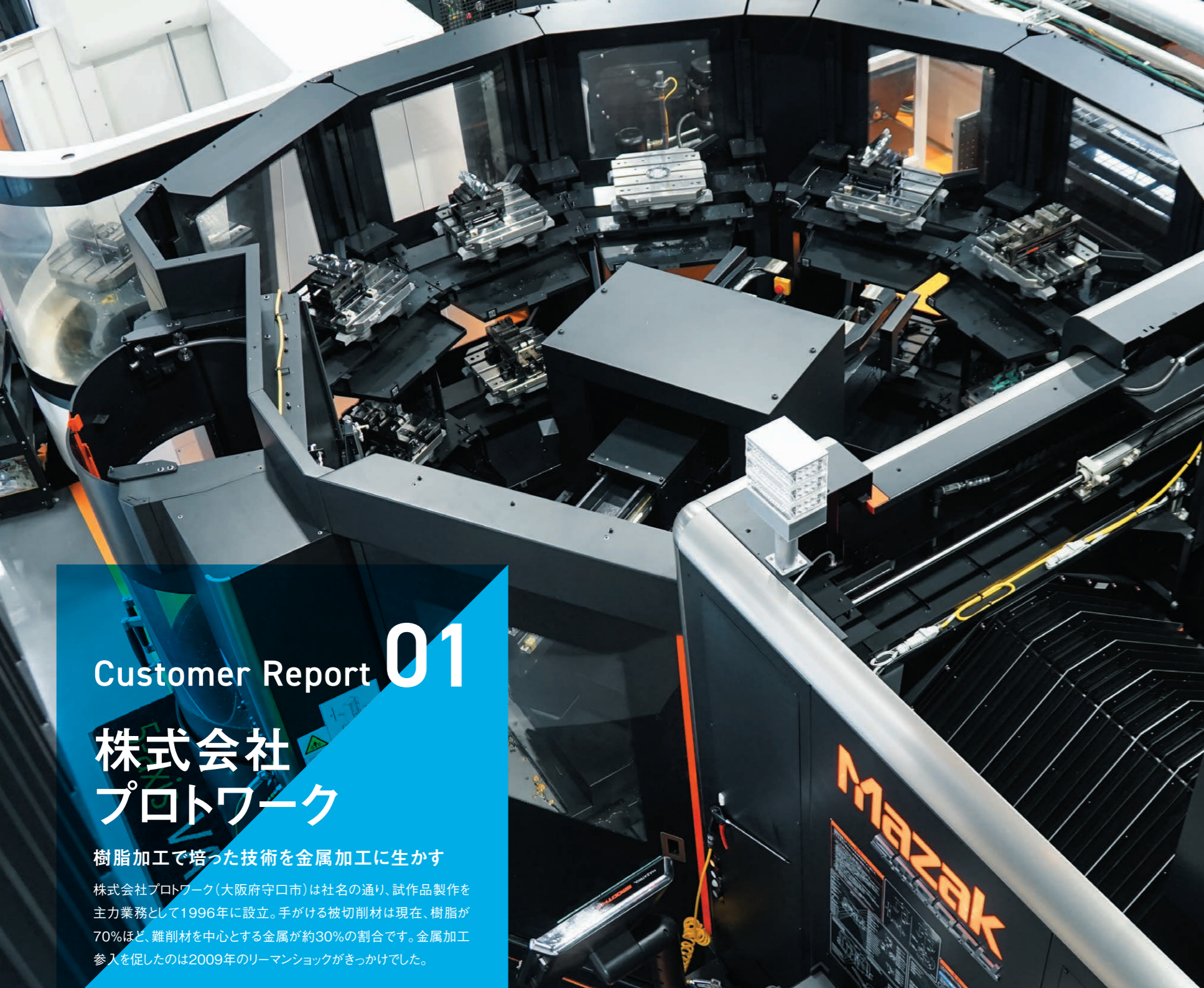
省スペース多段パレットストックシステム MPPのパレットにはさまざまな形状の試作品が並ぶ
