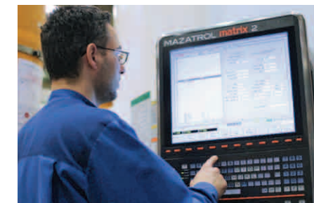
Facilità d'impiego grazie al sistema Mazatrol CNC a programmazione interattiva
