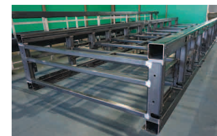
方便面成套设备的框架，通过马扎克的3D激光加工机进行高效率的加工
