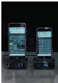
L'état de fonctionnement de la machine peut être contrôlé via un Smartphone utilisant Smooth LINK
