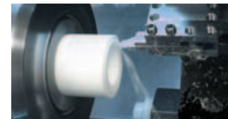
手研ぎバイトでの旋削加工
