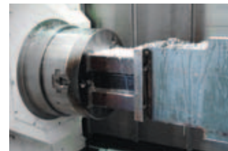
チャック部分に自作の治具を取り付け、作業効率・加工精度をさらに向上
