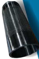
► Beispielwalzen mit feinen Löchern, die auf der INTEGREX gefertigt wurden
