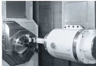
Автоматическая смена кулачков с помощью установленного крепления во фрезерном шпинделе
