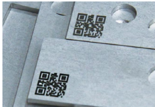
QR-коды * размечаются лазерным станком * QR-код является зарегистрированным товарным знаком DENSO WAVE Inc.
