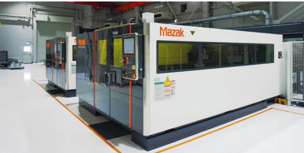
Современные оптоволоконные станки лазерной резки для обработки листового металла
