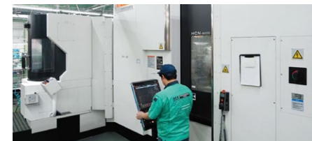
Горизонтальный обрабатывающий центр Mazak HCN-6000 с 6-паллетным сменщиком выполняет работу в автоматизированном режиме в течение продолжительных периодов времени
