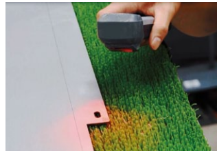
Оператор вызывает программу гибки, сканируя QR-коды, записанные на заготовках
