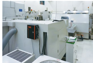
Информация для станков предыдущих поколений собирается с помощью MAZAK SENSOR BOX
