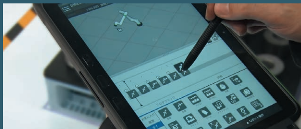
専用指令アイコンの組み合わせで直感的にプログラム作成
