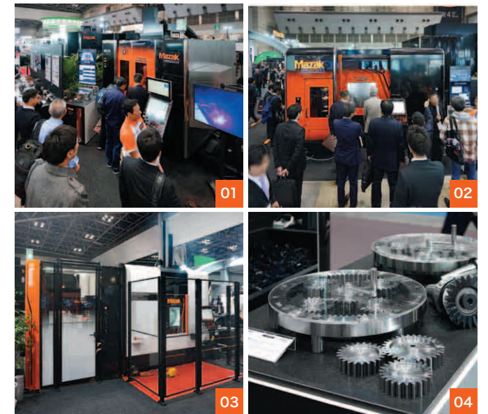
01. VARIAXIS j-600/5X AM (mit Blaulaser) für die Verarbeitung von reinem Kupfer bei der additiven Fertigung 02. INTEGREX i-200 AG mit integrierten Verzahnungs- und Messfunktionen 03. QUICK TURN 200M in Kombination mit dem Automatisierungssystem GL-50 04. Auf der INTEGREX AG gefertigte Musterteile
