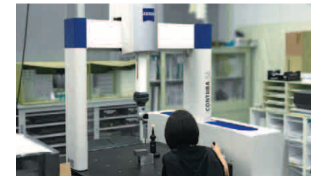
Einführung einer Koordinatenmessmaschine zur Gewährleistung höchster Präzision
