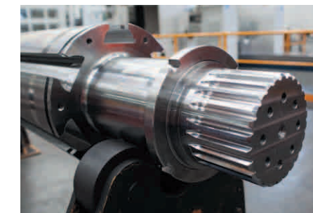
Detailaufnahme des Keilprofils und der Keilnuten an einer Klassiererwelle von FLSmidth ABON
