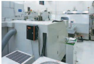
구형 설비기 및 주변기기 정보는 MAZAK SENSOR BOX를 경유해서 수집
