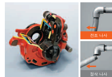
현장에서 쉽게 교체할 수 있는, 전조 나사 가공용 헤드(왼쪽)와 전조 나사(오른쪽 위)/절삭 나사(오른쪽 아래)의 내구시험 결과 절삭 나사 파이프는 구부러짐 쉽게 파손
