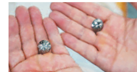
Teile mit 58 auf der INTEGREX j-200 spiegellatt bearbeiteten Facetten
