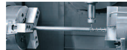
Die zweite Spindel der INTEGREX zieht das Werkstück um die programmierte Länge heraus – dies der Garant für kürzere Bearbeitungszeiten und supergenaue Schneckenbearbeitung
