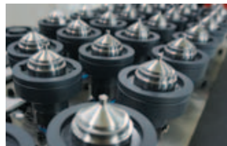
通过QUICK TURN SMART加工的热流道尖端喷嘴
