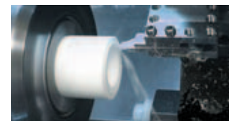
通过手研磨刀片进行的车削加工
