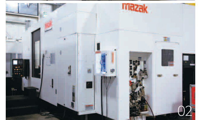
01. 시스코 시스템사와 공동 개발 한 MAZAK SMARTBOX™(프로토콜 타입) 02. MAZAK SMARTBOX™가 연결된 장비
