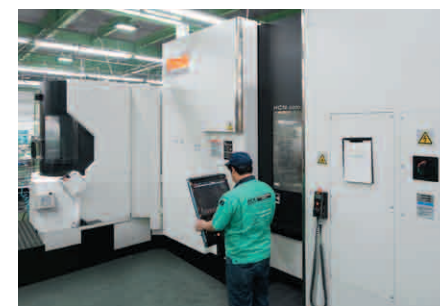
可长时间无人加工且附带6个托盘交换装置（pallet changer）的马扎克卧式加工中心HCN-6000
