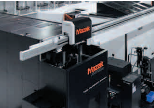
自动向多台设备提供刀具 (照片: 刀具运输系统)
