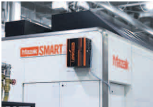
在机械加工区各处配置MAZAK SMARTBOX™, 以此收集设备的各种数据
