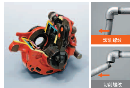
易于现场替换的滚轧螺纹加工用接头（左）和滚轧螺纹（右上）/切割螺纹（右下）的耐用性测试结果 若切割螺纹管弯曲则易导致螺纹破损
