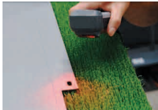
操作人员通过读取二维码, 调用折弯加工程序
