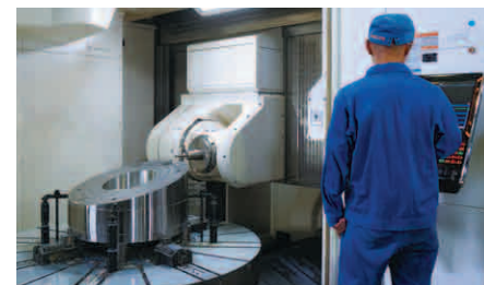
Lavorazione ad alta precisione di particolari di grandi dimensioni
