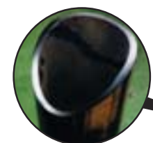
Taglio trasversale con profilatura 3D
