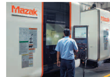
I centri di lavoro a 5 assi hanno permesso di ridurre le fasi di fabbricazione degli stampi
