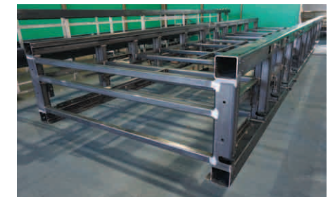
I telai delle macchine per fettuccine istantanee sono tagliati con grande efficienza mediante macchine per la lavorazione laser 3D Mazak
