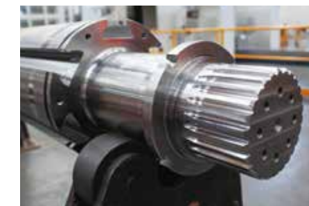
Detalhes das ranhuras e encaixes no Eixo do Dimensionador FLSmithth ABON
