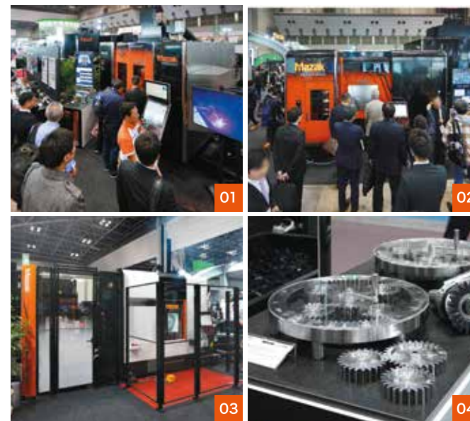
01. VARIAXIS j-600/5X AM (laser azul), que pode fabricar aditivo de cobre puro 02. INTEGREX i-200 AG, com funções integradas de corte e medição de engrenagem 03. QUICK TURN 200M, equipada com o sistema de automação GL-50 04. Exemplos de peças de trabalho produzidas pela INTEGREX AG
