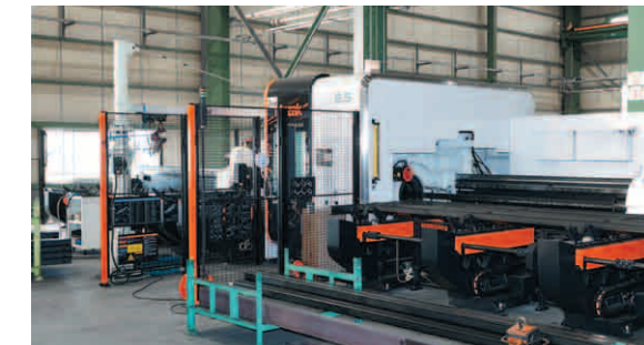
Le 3D FABRI GEAR 220 II sert à découper des tubes en acier en 3D
