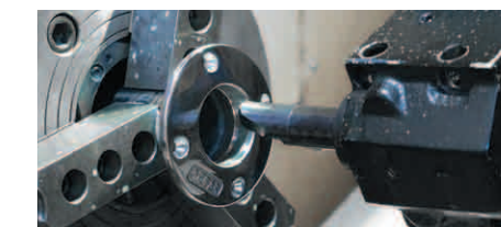
Usinage de finition sur l'intérieur d'un élément moulé à la cire perdue
