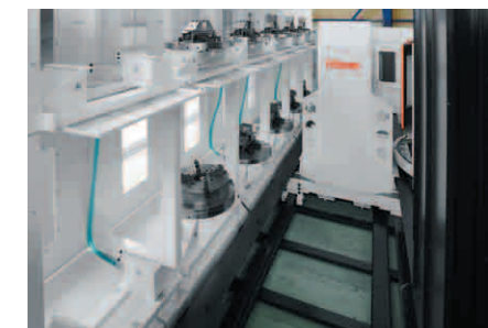
Système PALLETECH installé pour réduire davantage les temps de production
