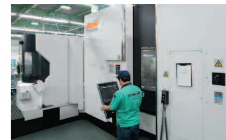
Le centre d'usinage horizontal HCN-6000 de Mazak équipé d'un changeur 6 palettes est capable de fonctionner sans opérateur pendant de nombreuses heures
