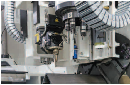
通过攻丝单元和接触时传感器,可以实现更高的工序集约
