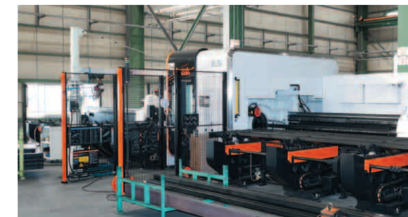
강관의 3차원 가공에 활용되는 3D FABRI GEAR 220 II
