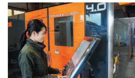
通过引进OPX DDL，实现各种材质、板厚的高速切割
