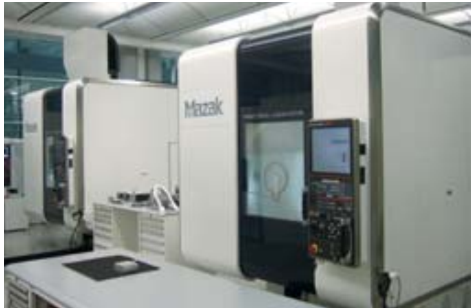
Zwei HYPER VARIAXIS 630 im Einsatz für die Bearbeitung von Rennwagenbauteilen
