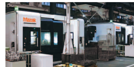
Équipement avec les dernières machines multitâches pour l'usinage de pièces sophistiquées aux formes complexes
