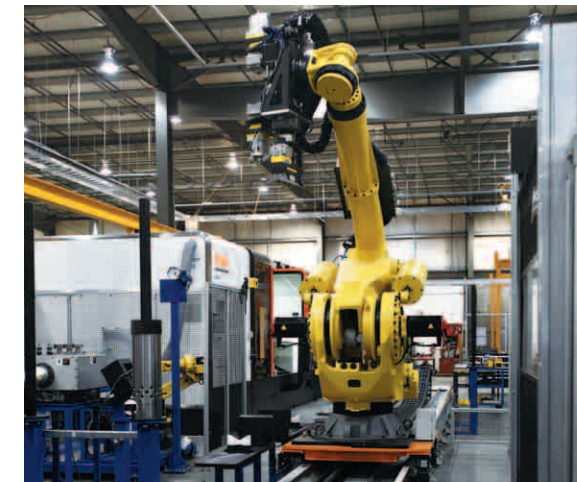
Automatisation avec des robots pour le fonctionnement sans surveillance
