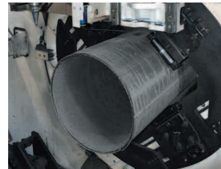
Système de serrage à rouleau à 4 mors pour le maintien sûr du matériau - même les tubes à parois minces ne sont pas endommagés
