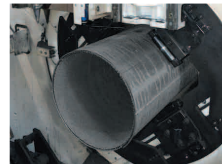
4-Backen-Rollenklemmsystem zum sicheren Halten des Materials – selbst dünnwandige Rohre werden nicht beschädigt
