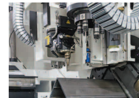
Gewindeschneideeinheiten und Messtaster neben dem Schneidkopf
