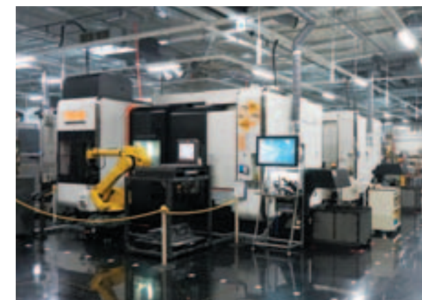
前後2台のINTEGREXにそれぞれロボットアームが搭載された自動化システム
