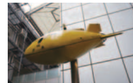
マザック機で製作された自律航行型の海中ロボット「ブテロA150」
