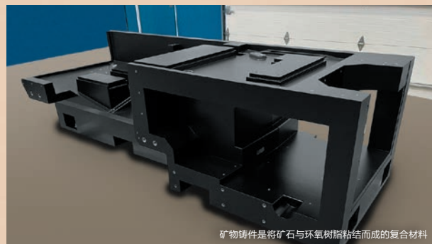
矿物铸件是将矿石与环氧树脂粘结而成的复合材料
