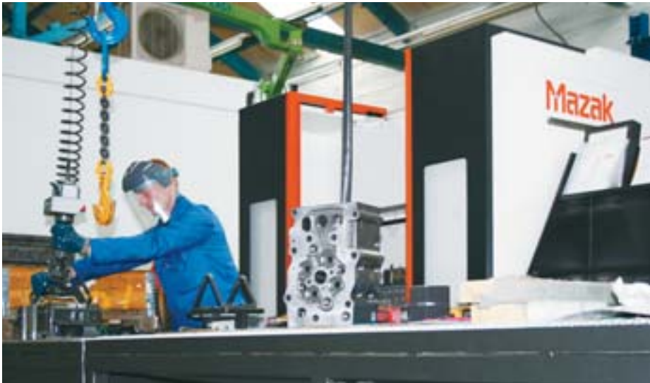
Opérateur machine lors du retrait d'une tête de piston complexe de l'une des nouvelles machines du type HORIZONTAL CENTER NEXUS 6000-II chez John Hyde Engineering
