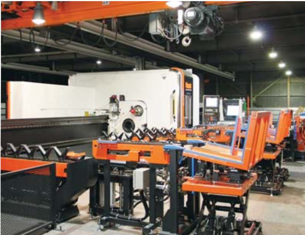
Système d'alimentation et de chargement développé par Korenaga Shoukai pour la 3D FABRI GEAR 220 II
