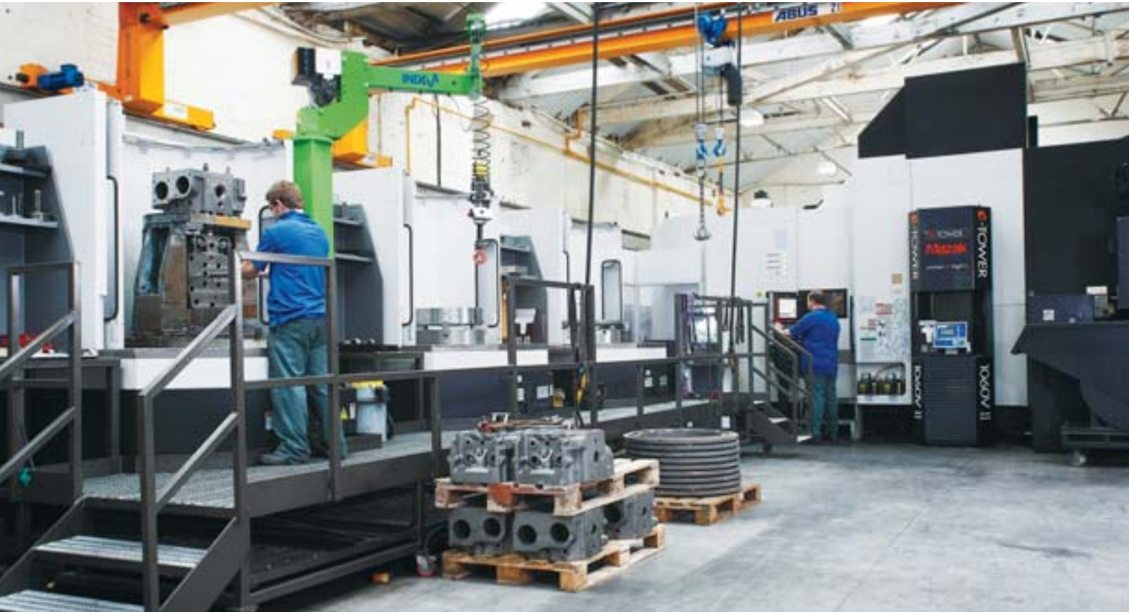
Le SYSTEME DE FABRICATION FLEXIBLE (FMS) de John Hyde Engineering utilisé avec un INTEGREX e-1060V II
