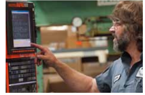
Оператор программирует ЧПУ MAZATROL
