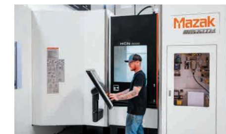
PALLETECH HIGH-RISE SYSTEM에 접속된 HCN-5000은 24시간 연속 가공을 실현하고 있다
