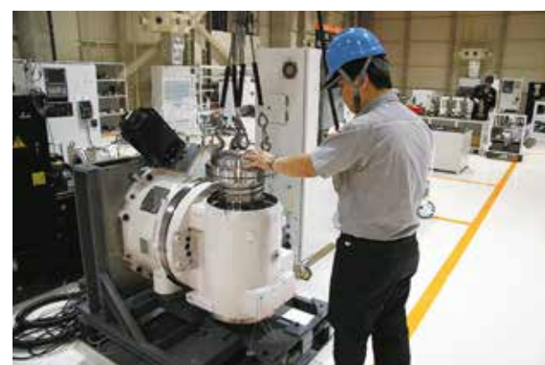
Фрезерный шпindel станка INTEGREX
