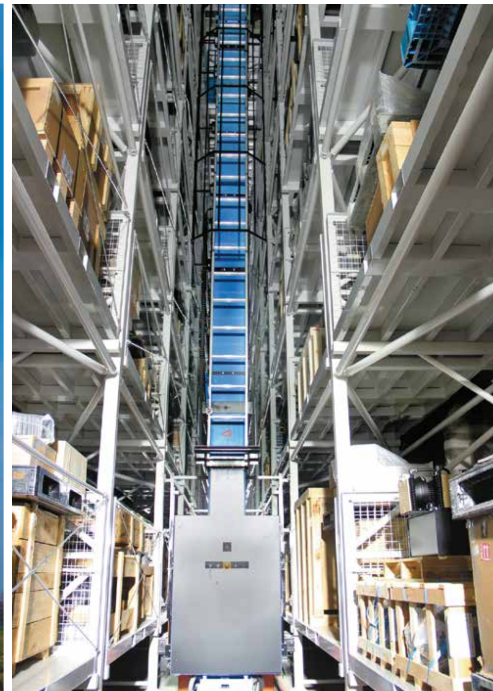
Вертикальные грузоподъемники с накопителями для средних и крупных запчастей и высокоскоростные автоматические грузоподъемники для мелких частей
