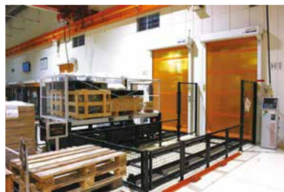
Крупные запчасти помещаются на высокоскоростные вертикальные грузоподъемники
