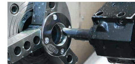
ロストワックス部品の内径仕上げ加工
