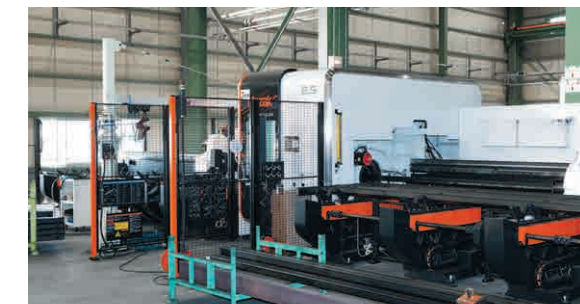
鋼管の3次元加工に活用される3D FABRI GEAR 220 II
