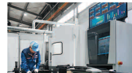
Le moniteur Smooth Monitor AX (en haut à droite sur la photo) facilite le partage de l'état de fonctionnement de l'équipement
