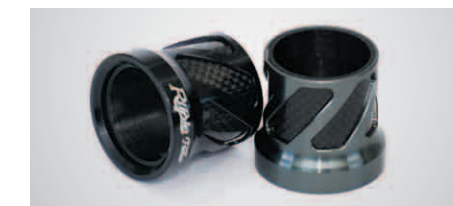
Pièces prototypes usinées par l'INTEGREX i-150
