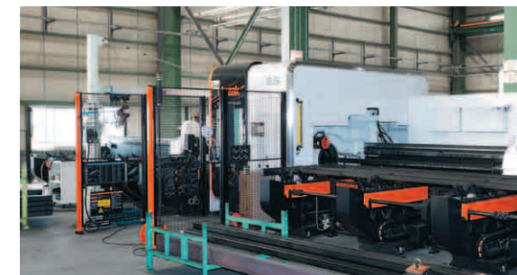
Il modello 3D FABRI GEAR 220 II è utilizzato per il taglio 3D dei tubi in acciaio
