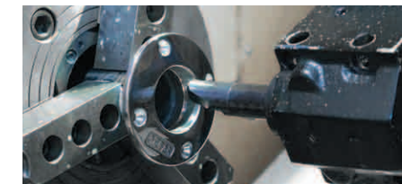
Lavorazione di finitura dell'interno di un componente ottenuto tramite fusione a cera persa
