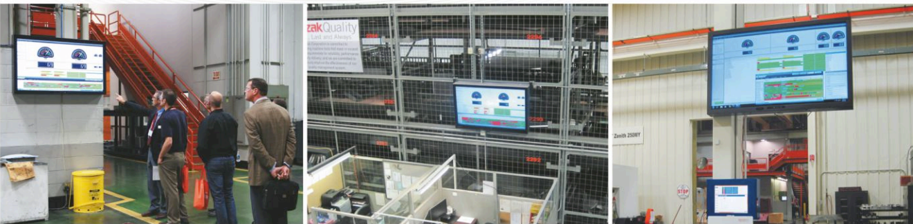
На больших дисплеях, установленных по всему заводу, отображен статус работы станков.
