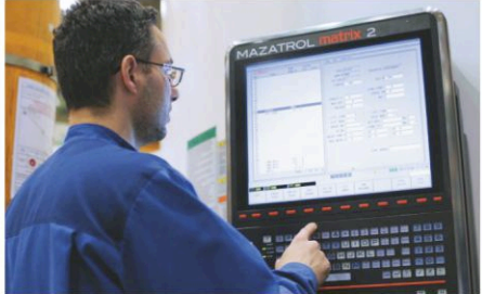
Простое управление с помощью системы диалогового программирования MAZATROL
