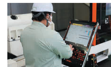
Mit ihrer hohen Bedienerfreundlichkeit ist die CNC-Dialogsteuerung vom Typ MAZATROL bei den Anwendern sehr beliebt
