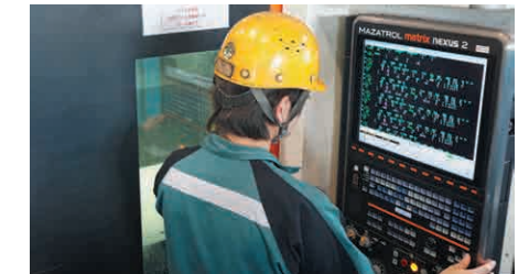
Selbst dringende Aufträge lassen sich durch die einfache Programmierung der MAZATROL schnell erledigen
