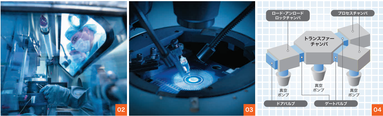
01. 半導体製造装置が多数並ぶ、最先端半導体工場(クリーンルーム) [提供:東芝メモリ株式会社] 02. 酸素や水を遮断する「グローブボックス」内での作業 03. シリコンウェハの電気的検査 04. 製造装置内のクラスターチャンバ模式図
