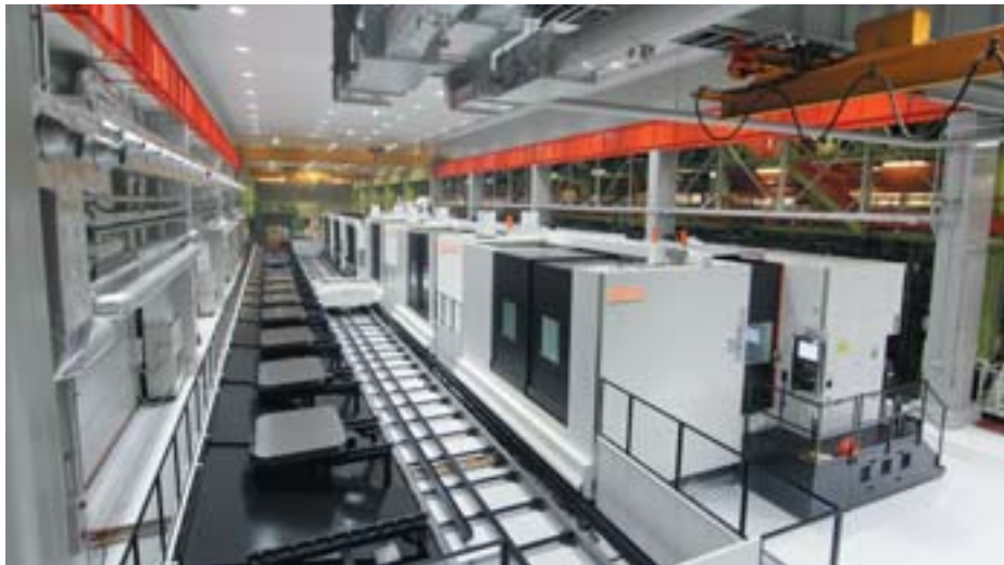
Neues Automatisierungssystem für die Bearbeitung großer Teile (Werk Oguchi, Japan)
