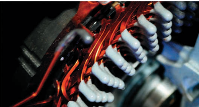
電気自動車のモータに組み込まれている電極
