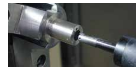
INTEGREXで加工される同社製品(タッチプローブ)の筐体
