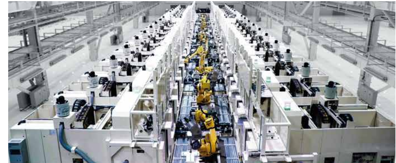
ターンキーソリューションの一例: 横形マシニングセンタ「FF-5000/40」と多関節ロボットによる自動車用エンジン部品の量産加工ライン
