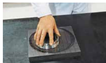
Притирка - точная отделка распорных граней на притирочном станке
