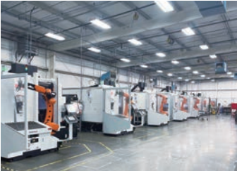
通过马扎克机床和机械臂的组合实现自动化
