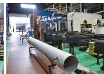
最大加工直径Φ406.4mm的管材加工
