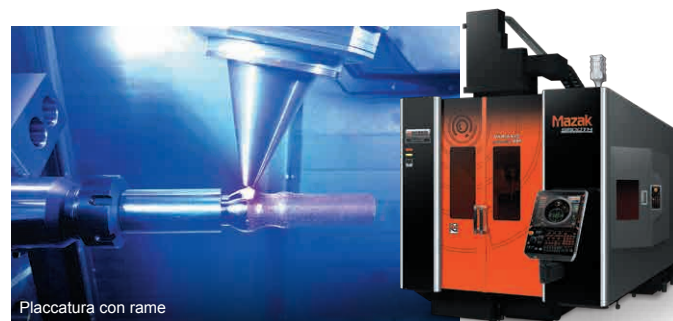
Una macchina utensile provvista di testa laser blu multi-raggio
