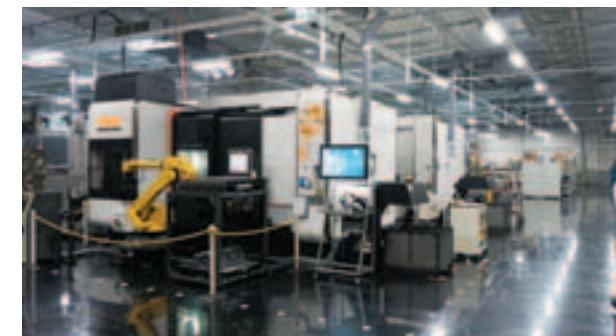
Système automatisé constitué de deux INTEGREX et de deux robots
