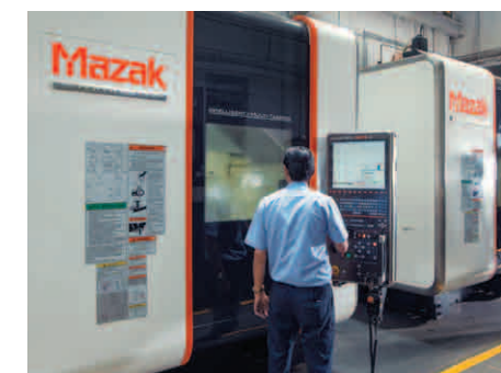
Verringerung der Schritte im Formenbau durch Einsatz von 5-Achsen-Bearbeitungszentren
