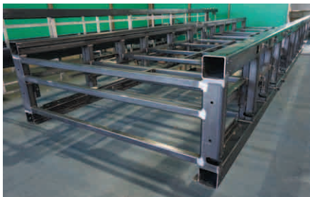
Rahmen der Instant-Nudel-Maschinen werden mit höchster Effizienz auf Mazaks 3D-Laserschneidmaschine geschnitten
